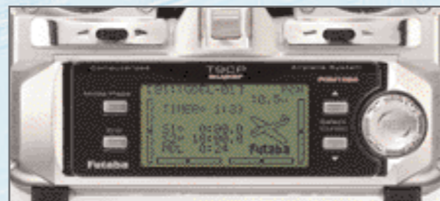
Zentrale Eingabeeinheit, mit 3-D Hotkey und LC-Grafik-Display
