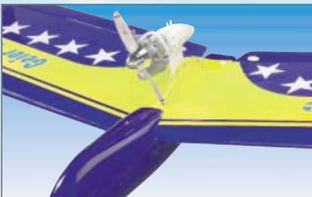
Motor mit Pylontank
