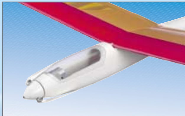
Motor und Luftschraube bereits montiert
