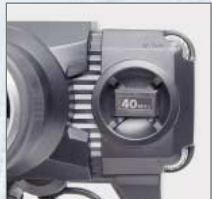
Günstig angeordnete Trimmregler für Gas- und Lenkung
